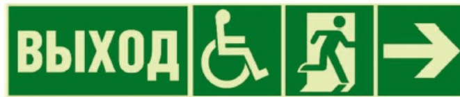
Рисунок 5 - Пример комбинации эвакуационных знаков
